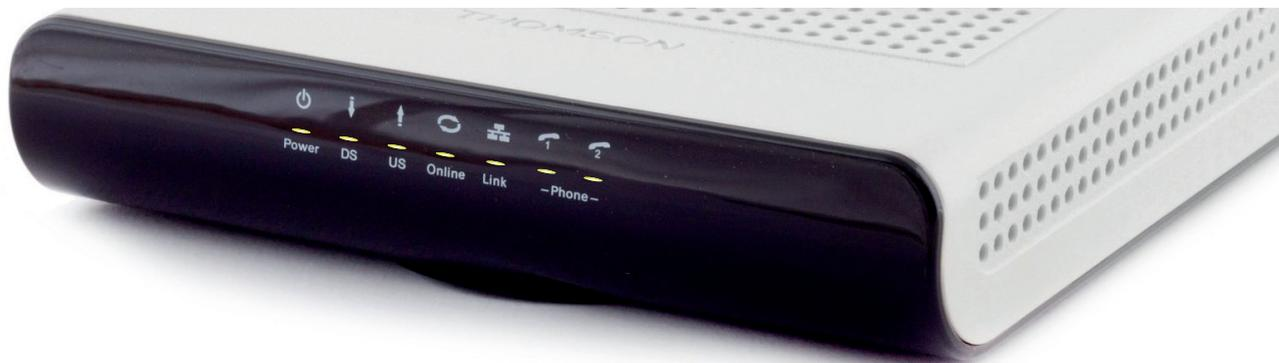
**Power:** Leuchtet sobald das Kabelmodem am Strom 230V angeschlossen und der Netzschalter (an der Rückseite des Kabelmodems) eingeschaltet ist.
