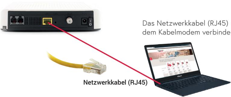
Das Netzwerkkabel (RJ45) mit dem PC oder Laptop und dem Kabelmodem verbinden.
